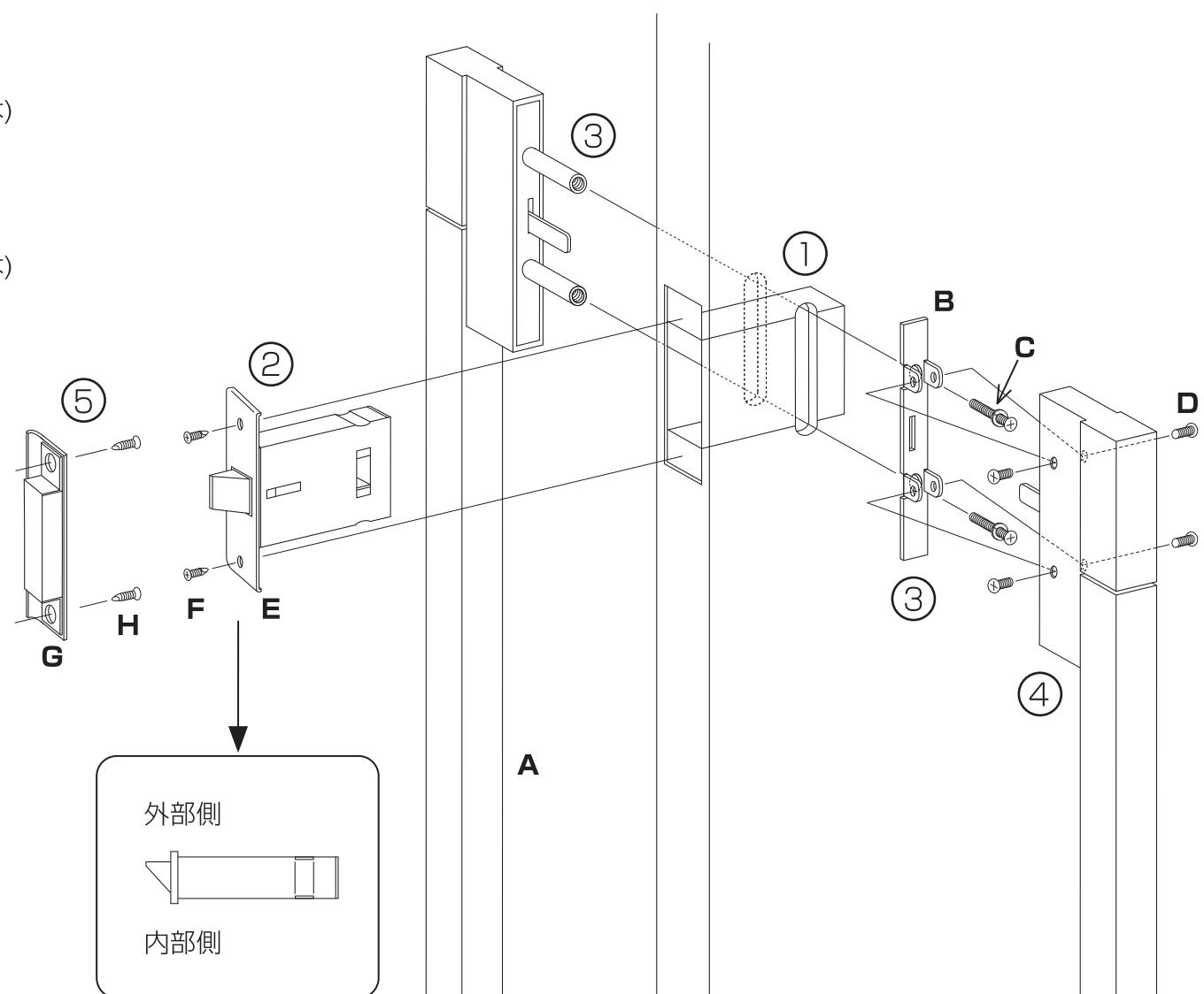
① 裏面の切カキ図に従ってドアを切り欠いてください
