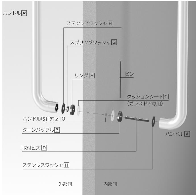
設置の際、ドアハンドルに印した赤マークの位置により取付ビス[D]の回転方向が変わります。
