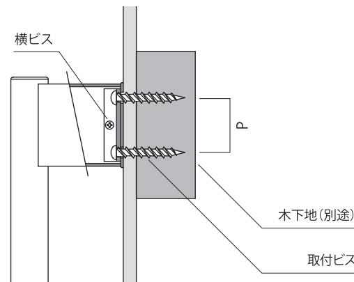
※取り付ける下地に合わせ必要に応じて下穴を開け固定してください。
