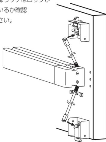
**8** 上部ラッチ金具カバー、下部ローラー金具カバー、下部ロッド棒カバーを取付ける。
