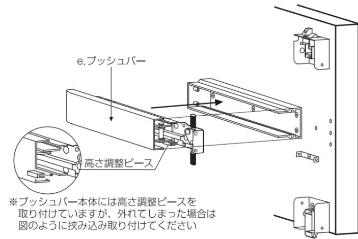
※プッシュバー本体には高さ調整ピースを取り付けていますが、外れてしまった場合は図のように挟み込み取り付けてください
