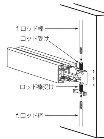
**6** ロッド棒をやや戸先側に倒し機構カバーの切り込みにはめながら、機構カバー内側上下の突起をベースの差し込み穴に差し込み、ビス2本で固定する
