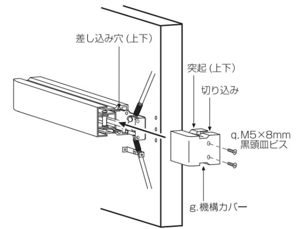
**7** 上下ロッド棒先端の金具を上部ラッチ金具、下部ローラー金具の切り込みにはめる。※プッシュバーを押し込んだ際、上部ラッチ、下部ローラーが引き込まれているか確認してください。
