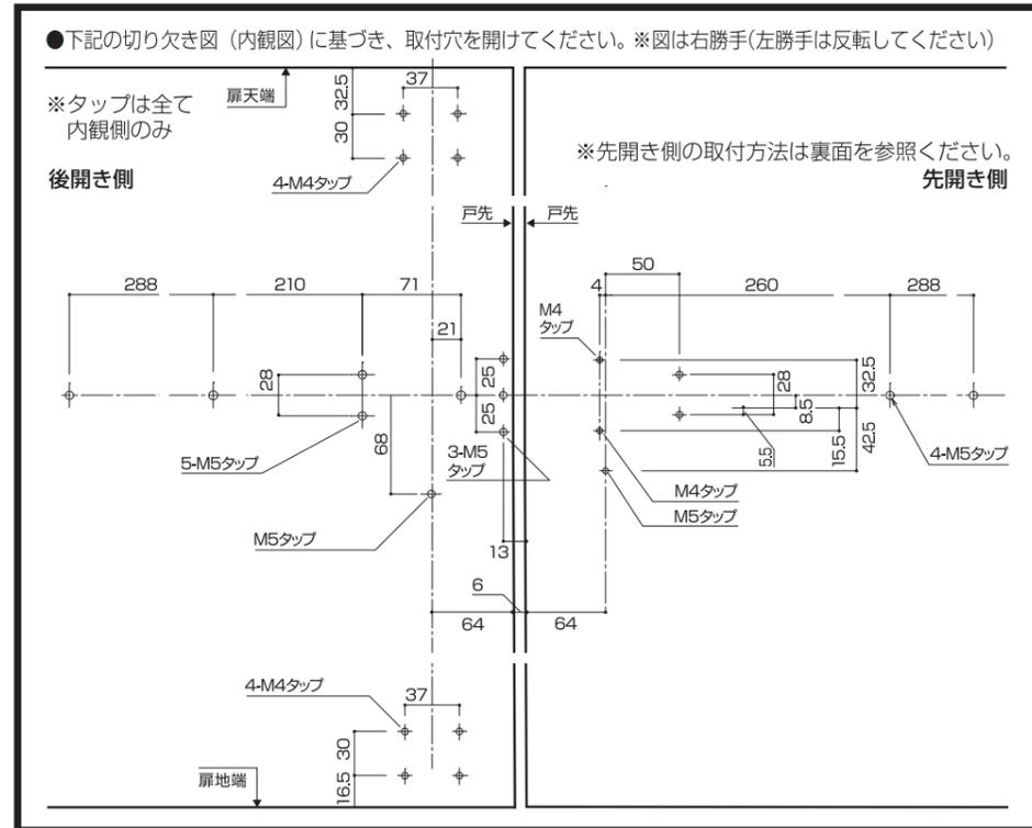
**1** ベースとC型金具を取付ける。(C型金具は水平にしてください)
