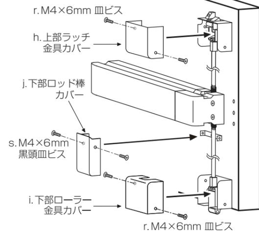
**9** 扉にセンターストライク、扉枠に上部ストライク、下部受け金具を取付ける。
