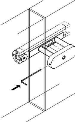
表示カバー側面の穴に開錠ピンを差し込み開錠します
