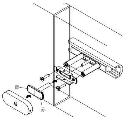
③表示カバーを表示カバー取付ネジで固定します
