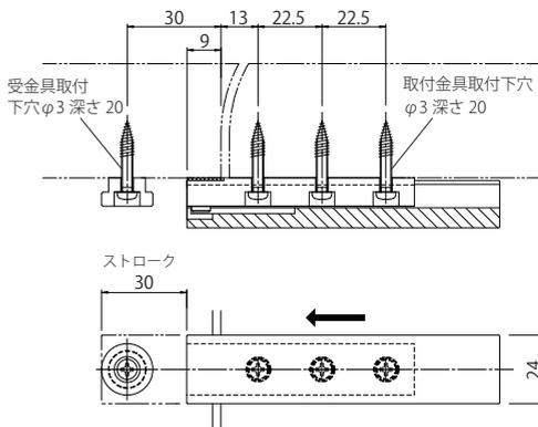
①納まり図に従いドアに取付部品をネジで固定します
